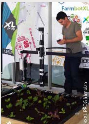
Créé par XL PROG, société spécialisée en programmation informatique de gestion, le Farmbot est un robot agricole permettant d'automatiser toute la production et l'entretien d'un petit potager, de la plantation des graines jusqu'à l'enfouissement des mauvaises herbes, en passant par la surveillance des sols et l'apport millimétré en eau. Doté d'une tête articulée sur trois axes, le robot peut couvrir l'ensemble du potager et changer automatiquement d'outils en fonction
